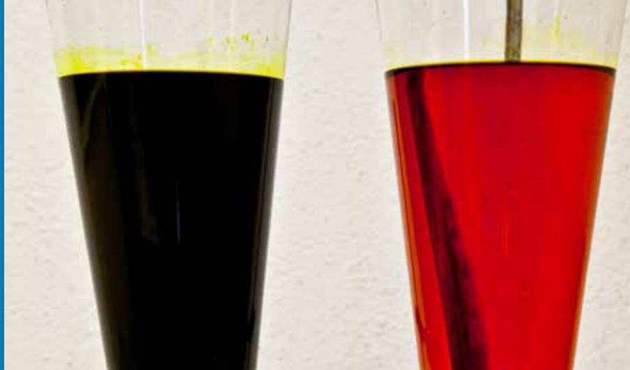
Elektrolyt vor und nach der Reinigung
