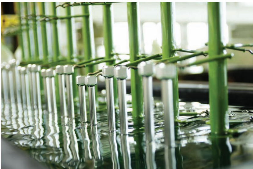
Die gespülten Werkstücke werden aus der Spülwanne gezogen. (Bild: Stalder AG, Engelburg)
